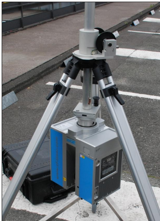
Fig. 5a: Scanner in „upside-down-mode“
