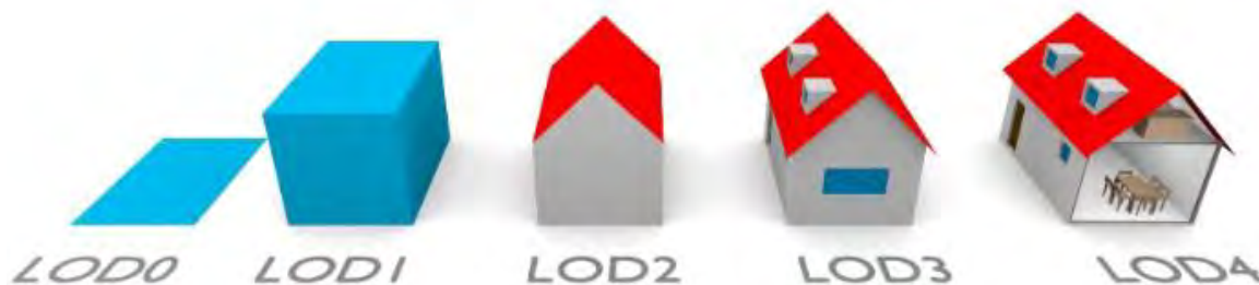
Зураг 2. CityGML 2.0-ын таван төрлийн LOD. Геометр хэсэглэлүүд болон агуулж буй мэдээллийн нарийвчлал нь нэмэгдсээр LOD4 түвшинд дотор орон зайн өгөгдлүүдтэй болдог байна (Билжекки нар., 2016).
